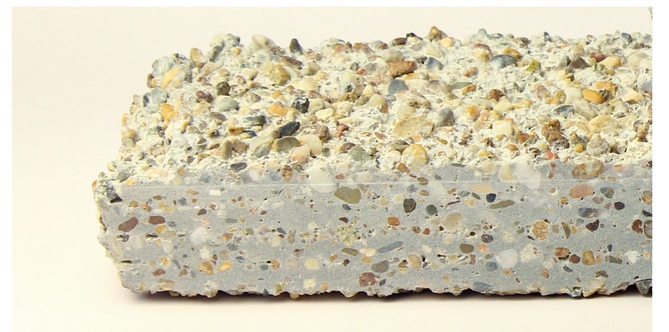
Ein Querschnitt durch den Hocker beweist: Das Substrat mischt sich im inneren der Drucke mit dem Binder und wird nicht verdrängt. Der Beton ist genau so belastbar und stabil wie herkömmlicher Waschbeton.
